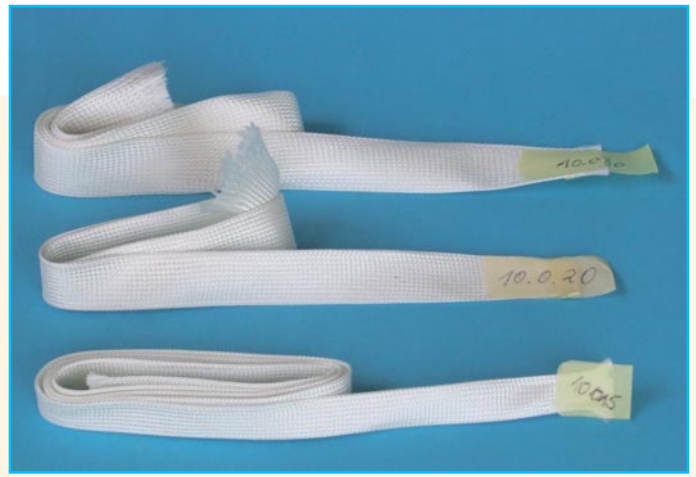
10 Eine kleine Auswahl verschiedener Flechtschläuche der Firma Bacuplast. Mit diesen Flechtschläuchen lassen sich Hülsen in hervorragender Qualität herstellen.
